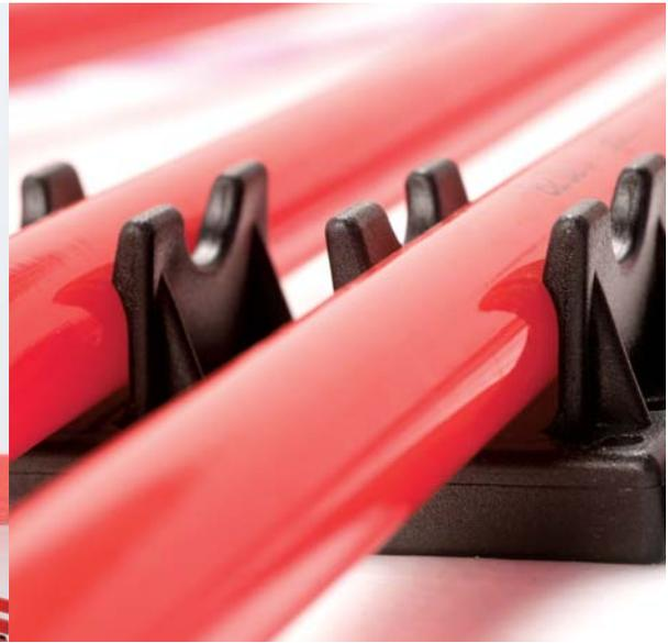
BETONCLIMA BARRASYSTEM risulta semplice da utilizzare e vantaggioso in ambienti con superfici non regolari, con forme circolari o disposti su più livelli. Questo sistema consente il completo annegamento del tubo nel massetto garantendo così la omogenea distribuzione del calore; inoltre il massetto risulta più robusto, essendo integro per l'intero spessore. L'impianto è realizzabile con uno spessore minimo di 9 cm, più lo spessore del rivestimento.
